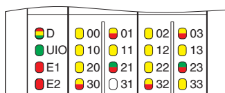
Bild 4 Lokale Diagnose- und Statusanzeigen
